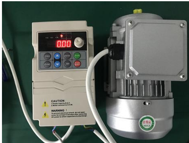
示例 1：监控带 RS485 接口的变频器
