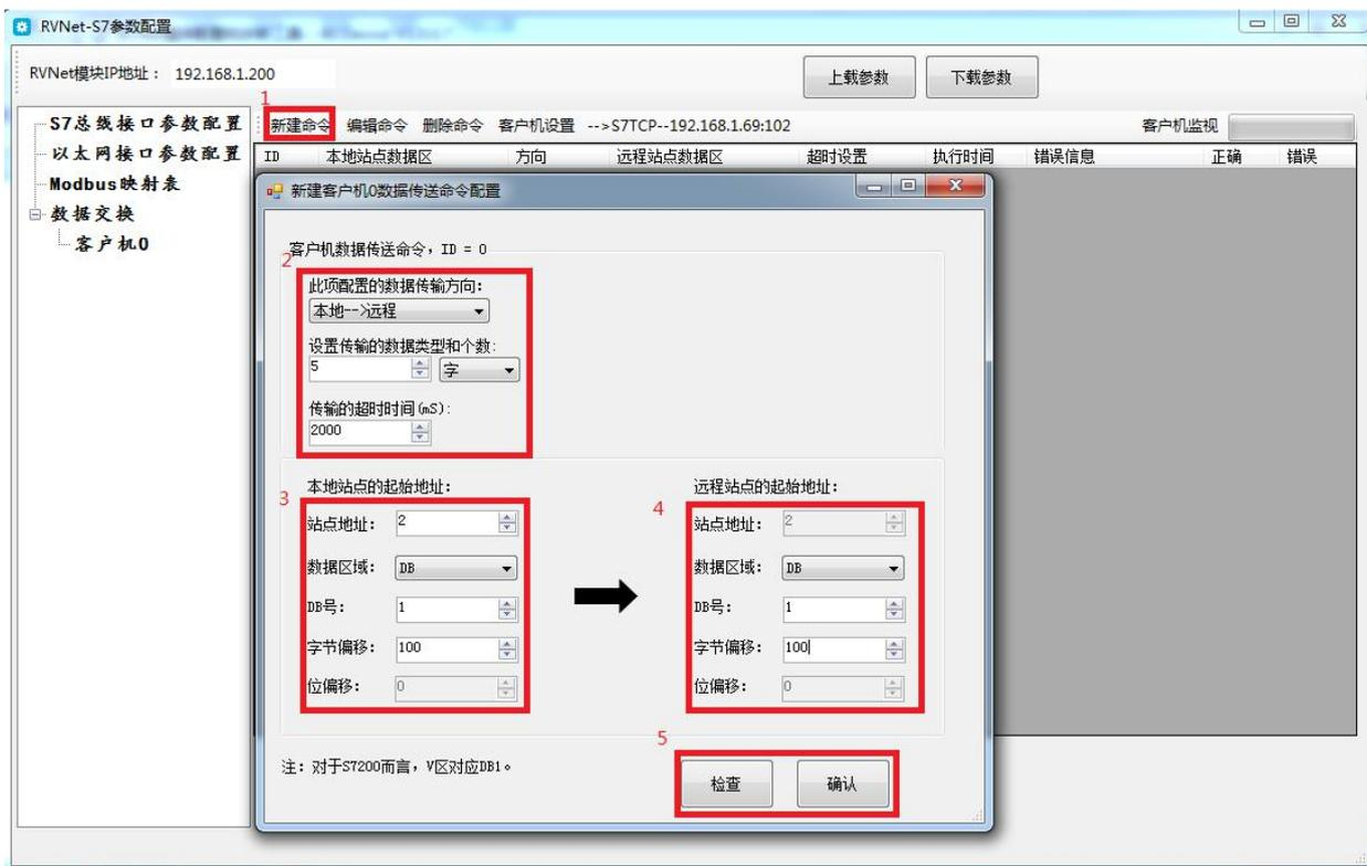
➤ 点击新建命令 (SMART200 的 VW100~VW108 读取 S7-200 的 VW100~VW108)；
