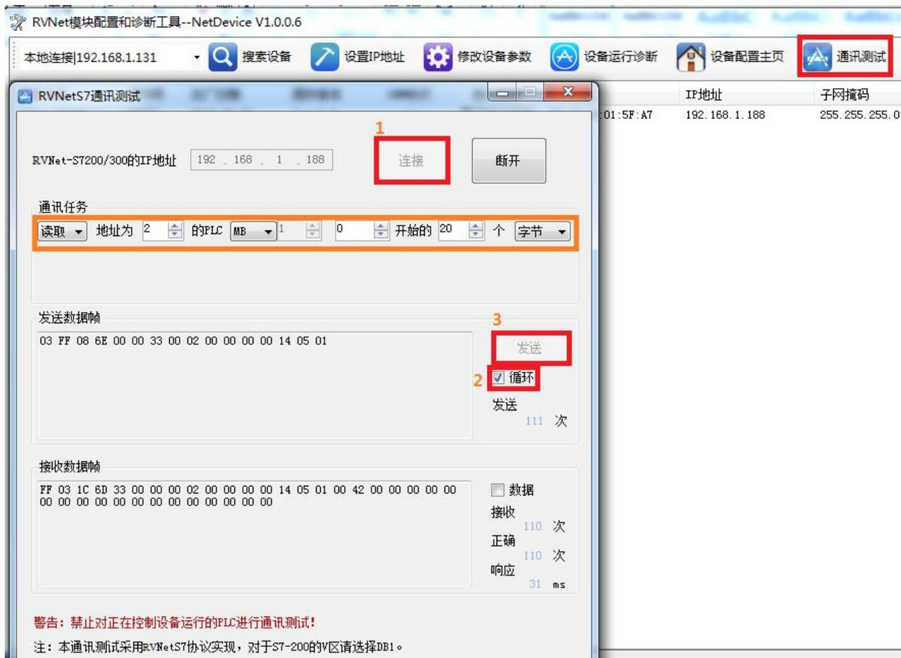
这里我们读取了 PLC 的 MB0~MB19 共 20 个字节的数据，如果通讯正常，则会返回 MB0~MB19 共 20 个字节的数据（最直观的方法：如果接收次数和正确次数一直是累加的话，表面通讯正常），可以借此来判断 RVNet-S7 模块、PLC、上位机之间的以太网连接是否正常。
