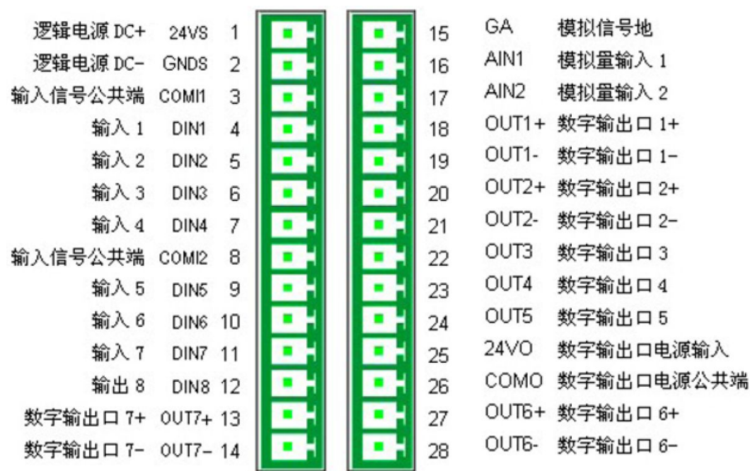
图 3-2 JD 驱动器 I/O 接线端子定义图
